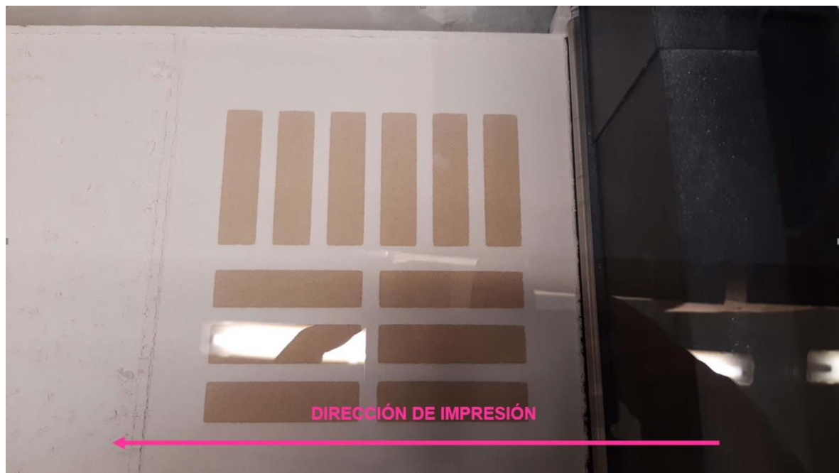
Fig. 3. Probetas imprimiéndose en la impresora Zprinter .
