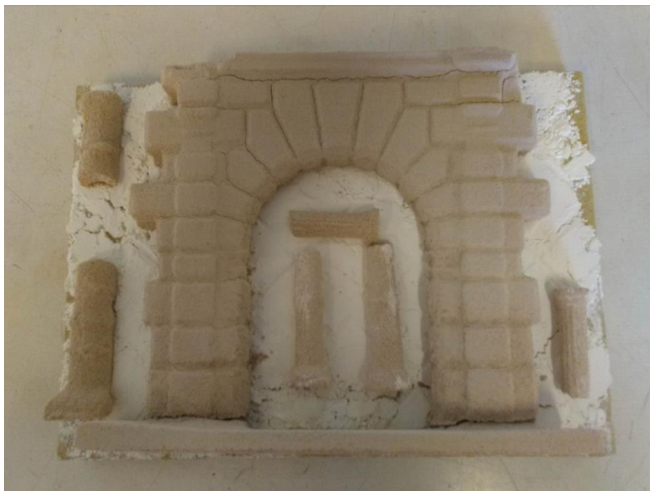
Fig. 1. Resultado de las primeras pruebas realizada con material cerámico tras cocción.
